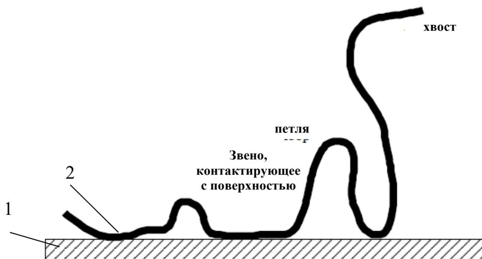
1 – поверхность частицы; 2 – макромолекула полимера
